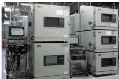
絶縁劣化特性評価テスト（SIR13） + 低温恒温恒湿器（HIFLEX NEO-S）
