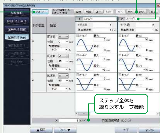
多軸サイン波組合せ試験 負荷条件設定画面
