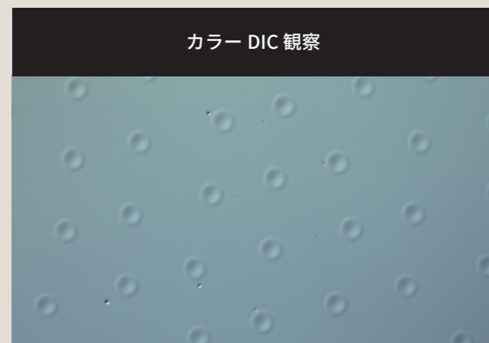
ハードディスクのランディングゾーンの比較画像
