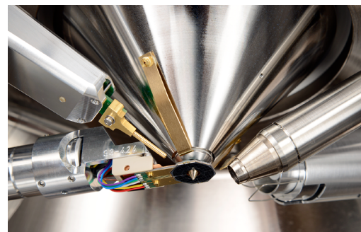
環状反射電子検出器（aBSD）が対物レンズのポールピースの下に取り付けられたチャンパー内部。これにより、低真空（NanoVP lite モード）イメージングが可能に。
