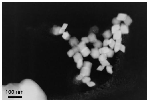
25 ～ 50 nm の酸化鉄粒子。aSTEM 検出器を使用して、暗視野モード、20 kV でイメージング。
