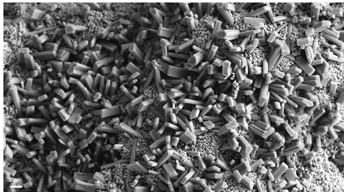
デンドライト構造酸化亜鉛のこの画像は、エネルギー貯蔵システムの電極の形態変化の検出に役立ちます。Sigma で ETSE 検出器を使用した二次電子イメージング。
