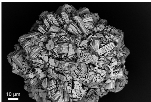
炭酸ランタン、Inlens Duo BSEを使用して1 kVでイメージング。 \text{LaCO}_3 は、透析患者の口腔治療剤に使用されるリン酸塩結合剤です。
