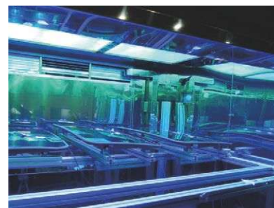
照射サービス実施例 （自動車用サンルーフユニットの超促進耐候性試験）
