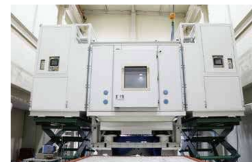
大型バッテリーパック試験対応 恒温恒湿槽付 振動試験装置
