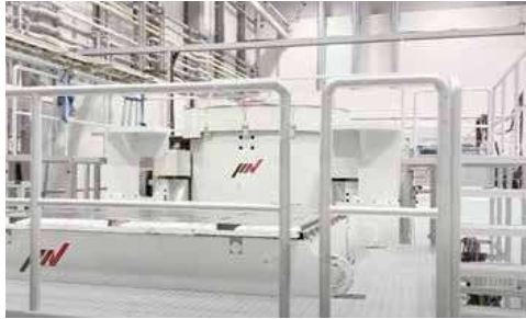
水冷式 350kN 大型振動試験装置
