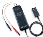
1 kV、2 kV、6 kV CAT安全定格モデル最も広い差動電圧範囲、卓越したCMRR、低ノイズ、1%のゲイン精度
