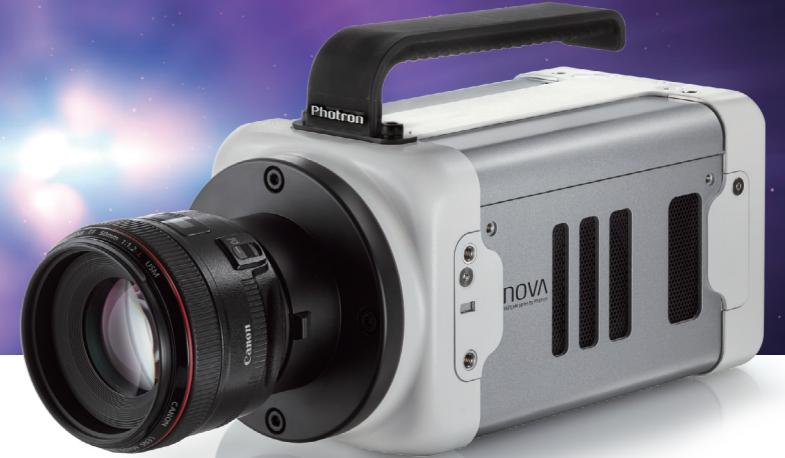
「FASTCAM Nova S シリーズ」は、120×120×217.2 mm、質量 3.3kg という小型軽量密閉筐体でありながら、100 万画素 (1024×992 画素) で 20,000 コマ / 秒、最高 1,100,000 コマ / 秒<sup>※1</sup> という高速撮影性能を実現したハイスピードカメラです。撮影性能別で 5 つのラインナップを備えており、お客様に最適な仕様をご選択いただけます。モノクロ ISO 64,000 / カラー ISO 16,000 という超高感度センサーを搭載し、燃焼、切削、溶接など様々な分野で活用いただけます。
