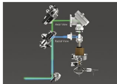
デュアルビューテクノロジーは、低い検出下限が求められるサンプルにはアキシアル測光で、高濃度までの検量線範囲を広げるためにはラジアル測光で測定できます。
