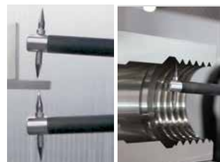
T字スタイラスによる上下測定例 厚み測定 (左) / 直径測定 (右)
