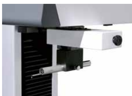
三次元表面粗さ測定例 検出器移動型 Y 軸定ピッチ駆動部
