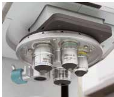
最大 5 つのレンズを搭載できる レボルバ機構 (R タイプ)
